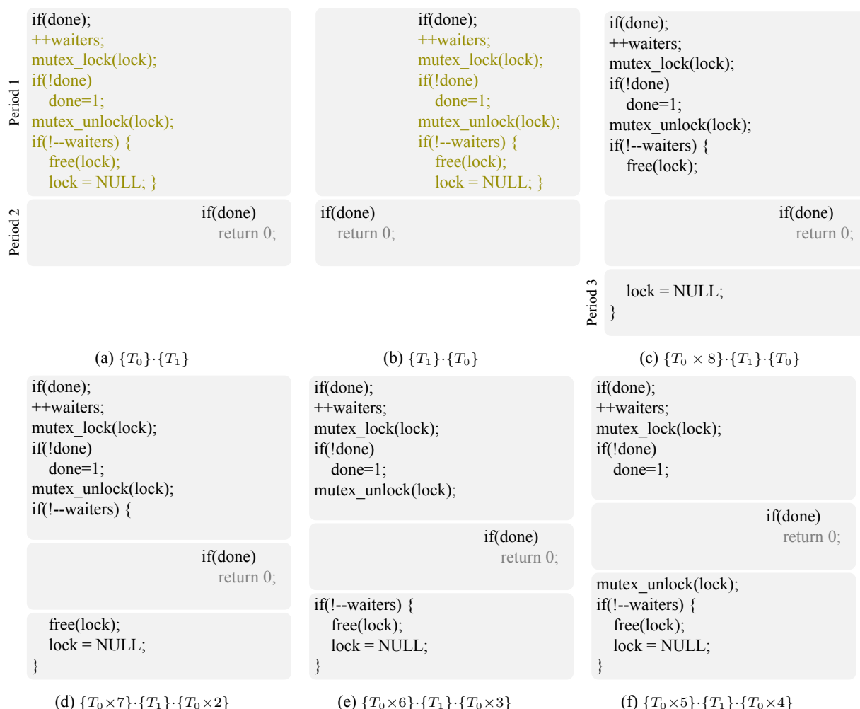
图 5-4 CVE-2016-1972 示例程序的线程交错情况。每个子图分别描述了一个调度决策对应的动态执行轨迹
